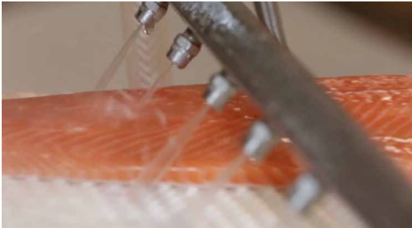
Sistema de lavado con agua ozonizada. Foto: Ozark Technologies
